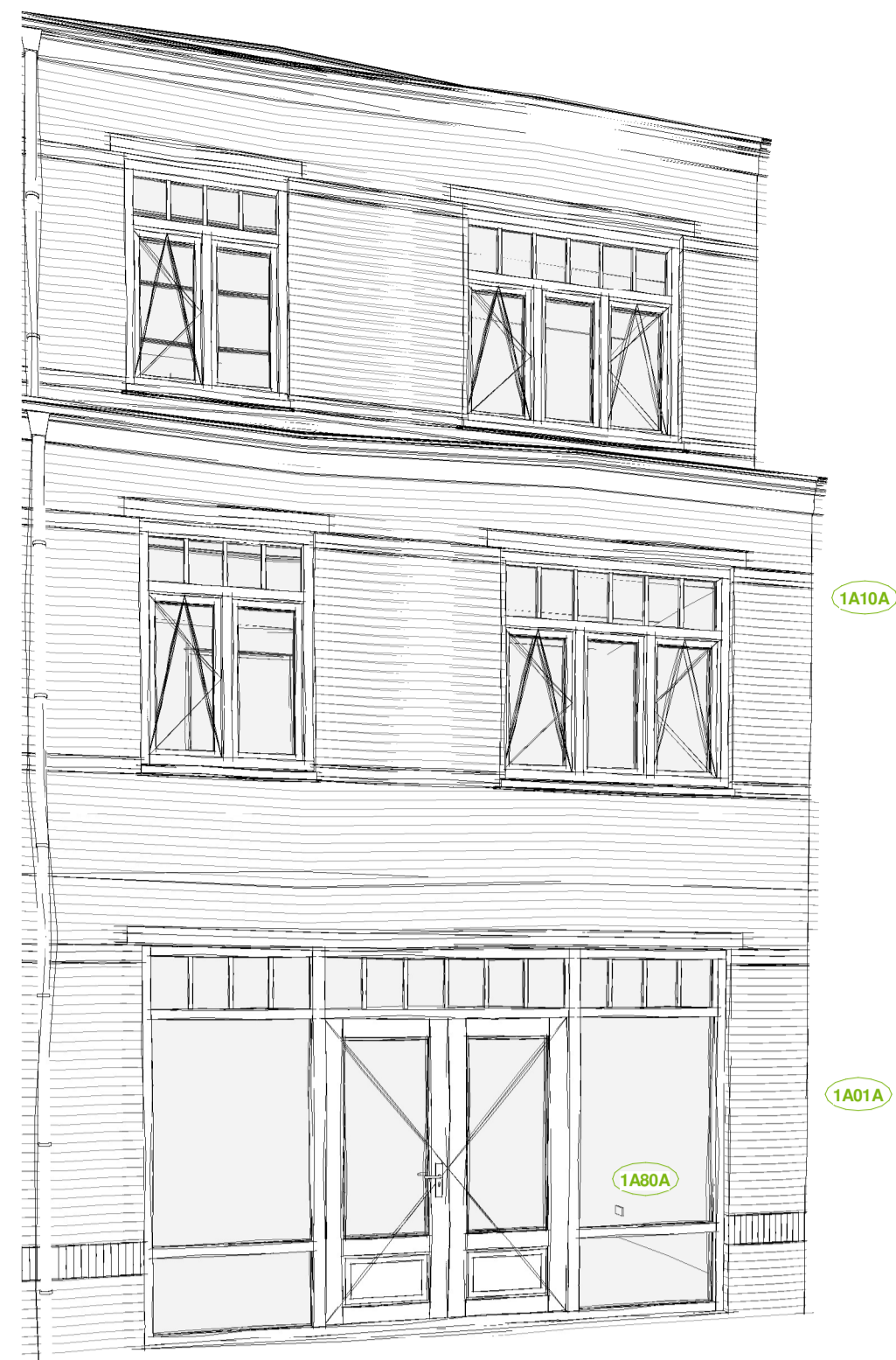
1A01A - Uitbouw 0.9m 1A10A - Uitbouw 1e verdieping 0.9m 1A80A - Pui met een dubbel opstaande deur en zijlichten
