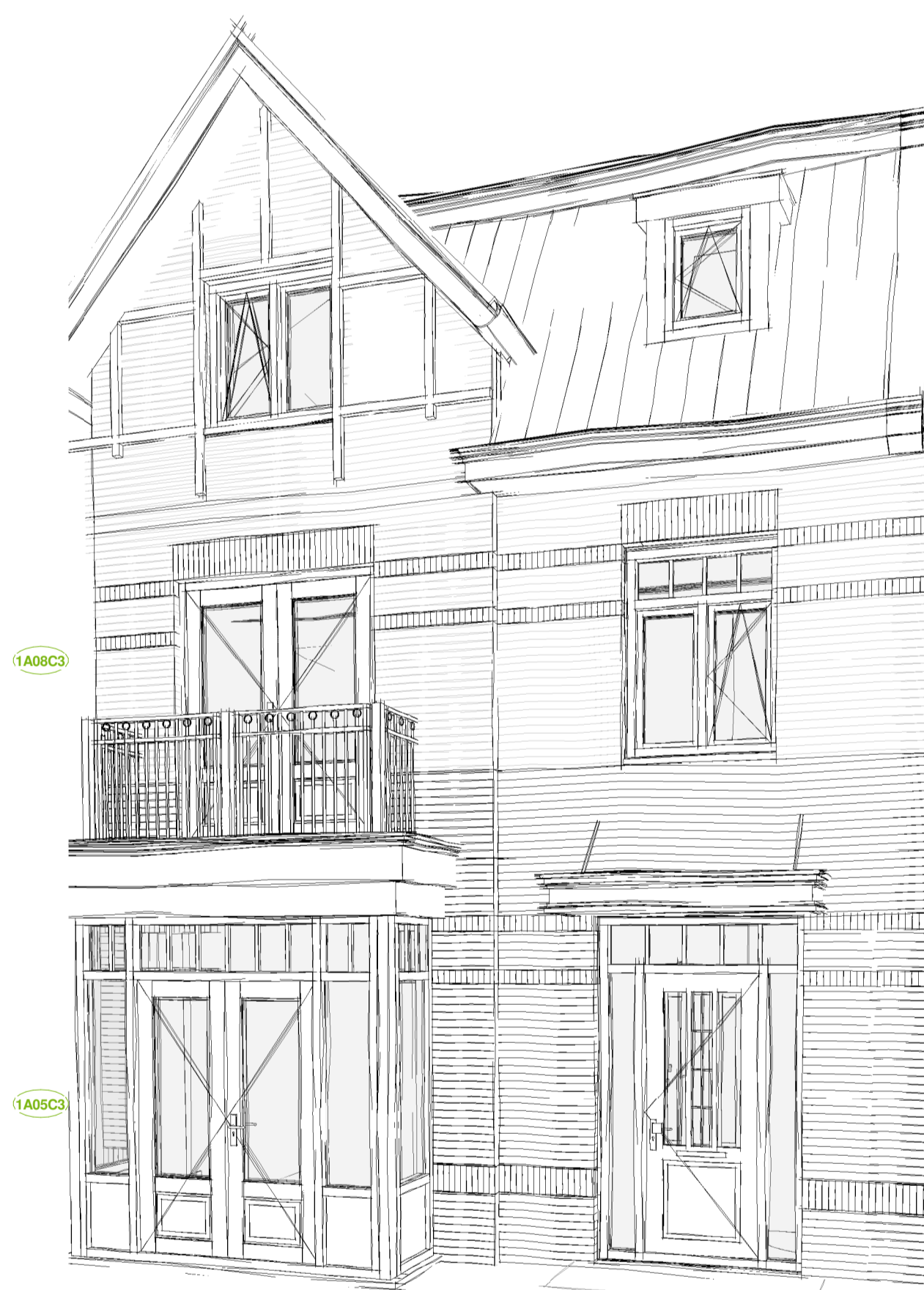
1A05C3 - Erker aan voorgevel 1A08C3 - Balkon op dak erker voorgevel
