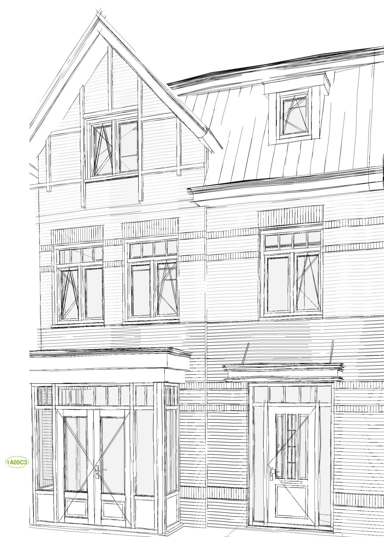
1A05C3 - Erker aan voorgevel
