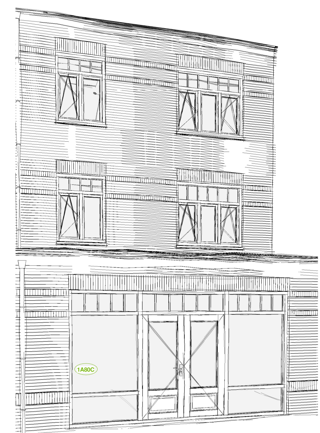
1A03C - Uitbouw 2.4m 1A80C - Pui met een dubbel openstaande deur en zijlichten
