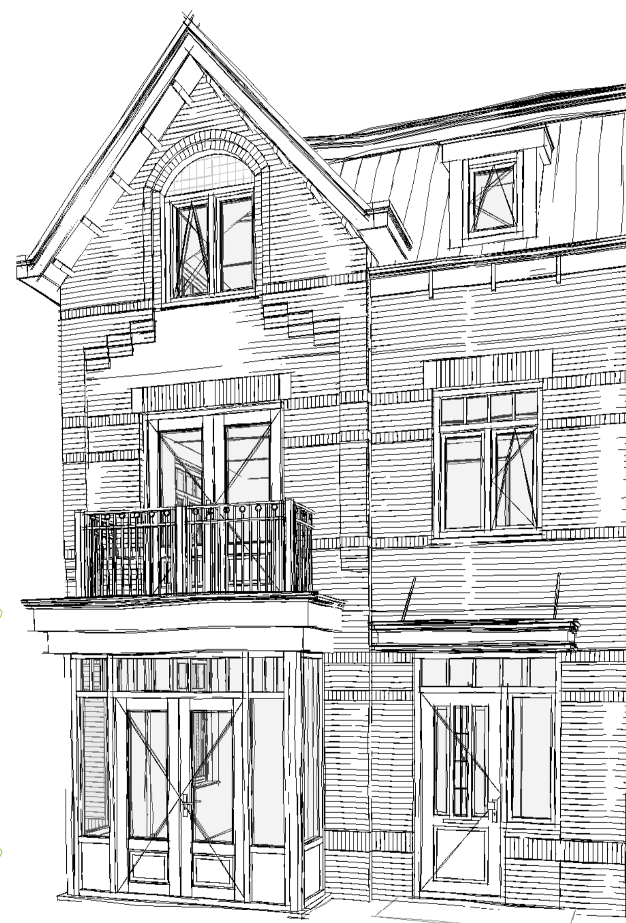
1A08B - Balkon op dak erker voorgevel 1A05B - Erker aan voorgevel
