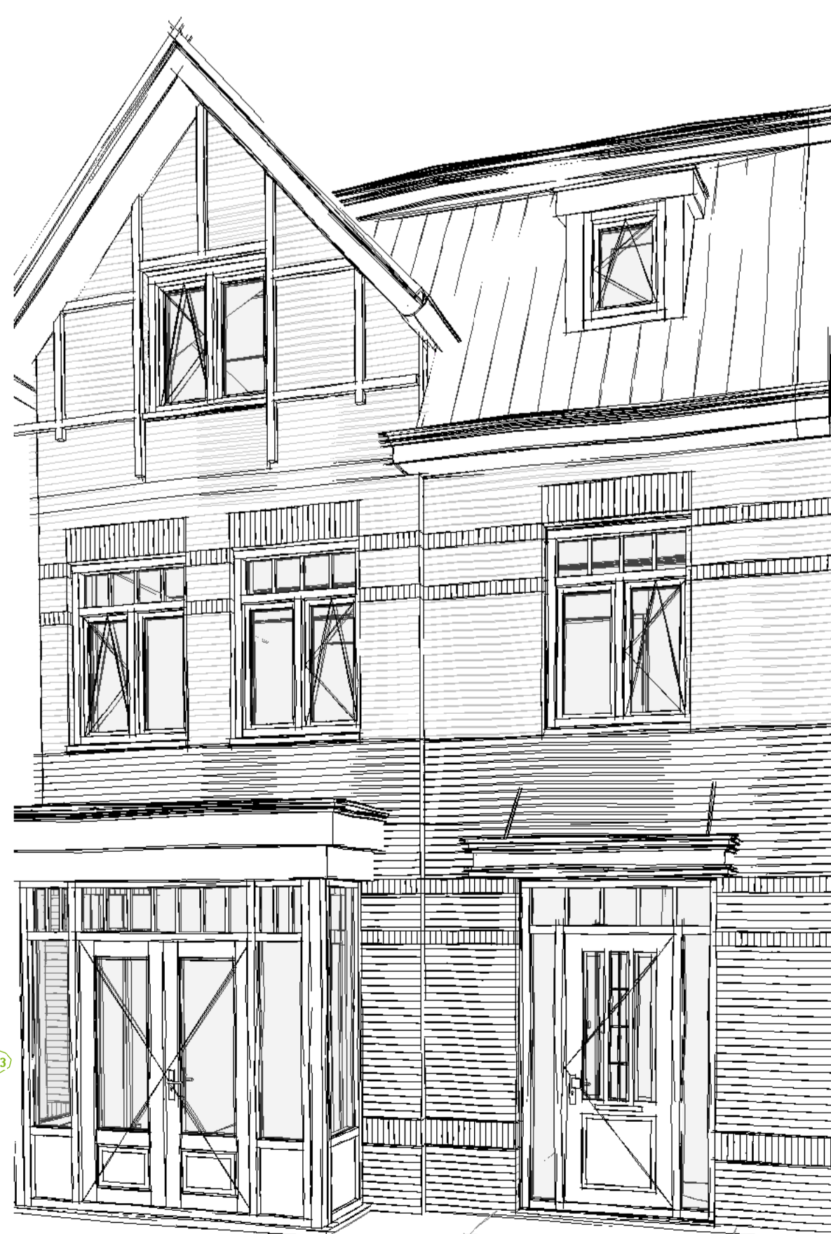
1A05C3 - Erker aan voorgevel
