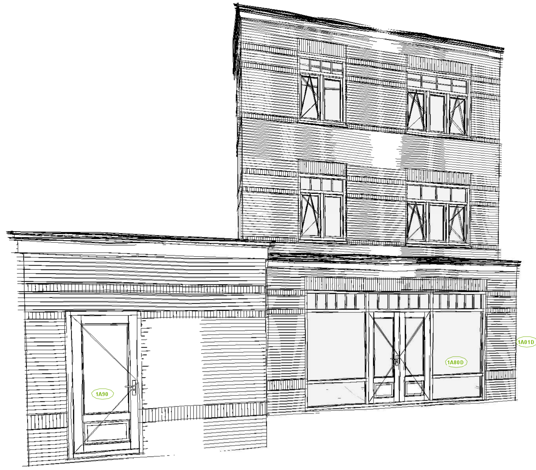
1A01D - Uitbouw 0.9m 1A80D - Pui met een dubbel openslaande deur en zijlichten 1A90 - Deur in achtergevel garage
