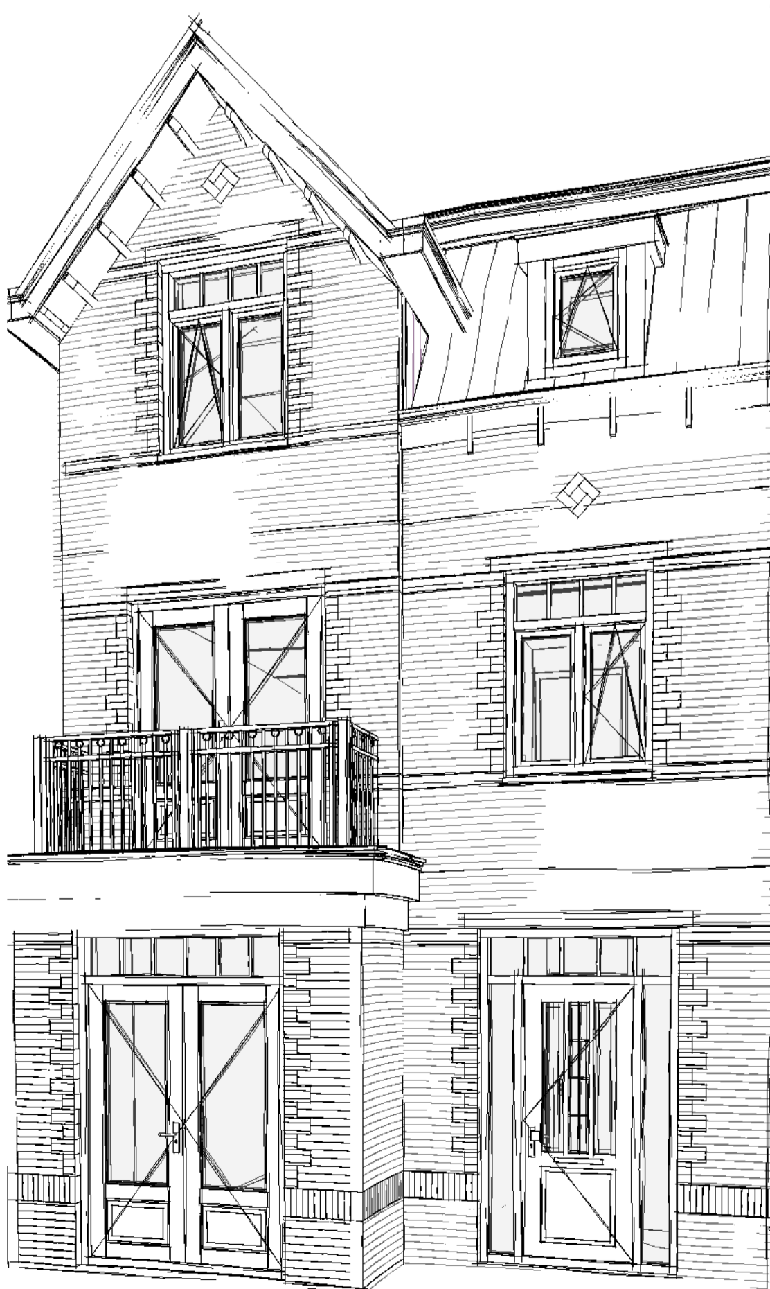
1A05A - Erker aan voorgevel 1A08A - Balkon op dak erker voorgevel
