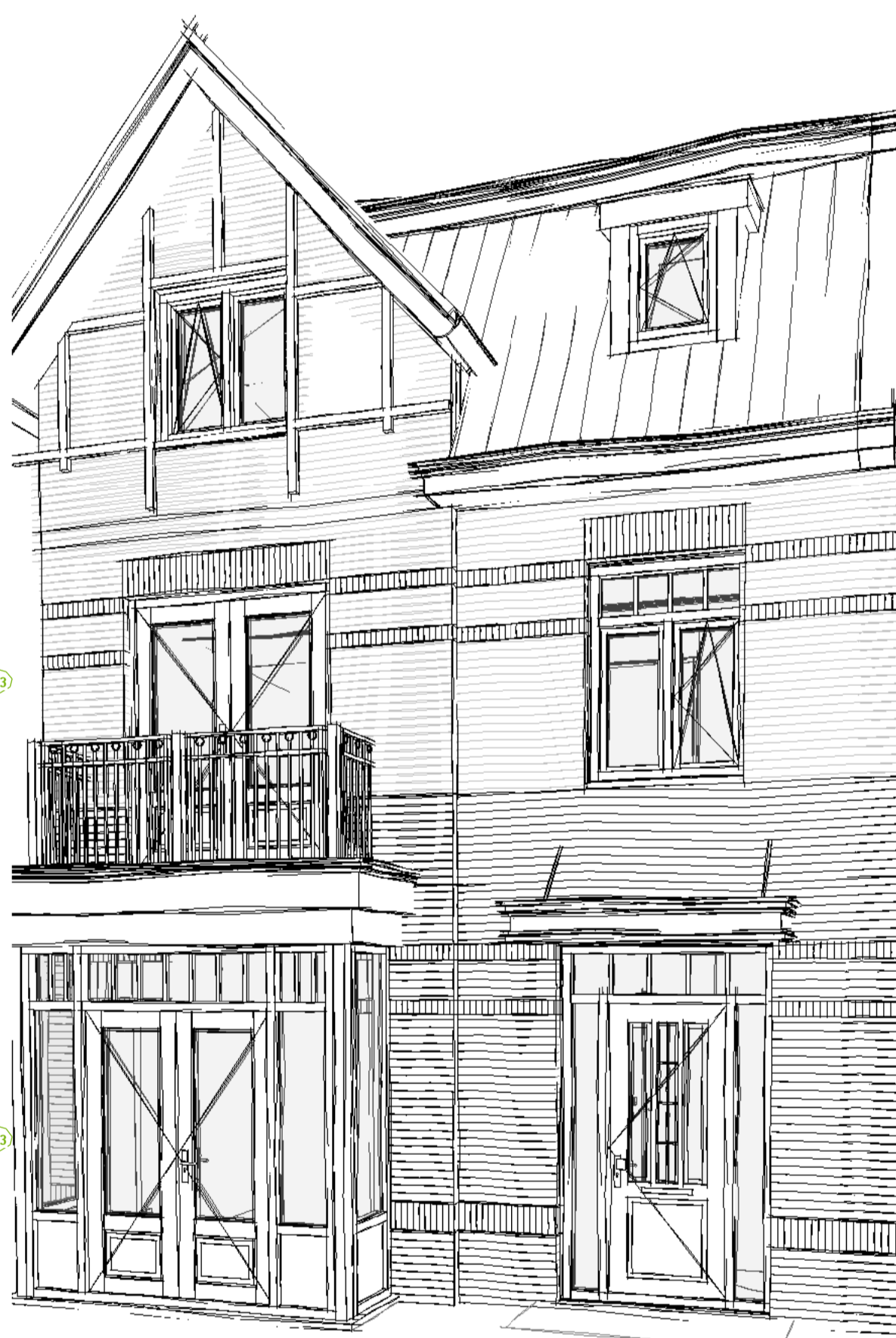
1A05C3 - Erker aan voorgevel 1A08C3 - Balkon op dak erker voorgevel
