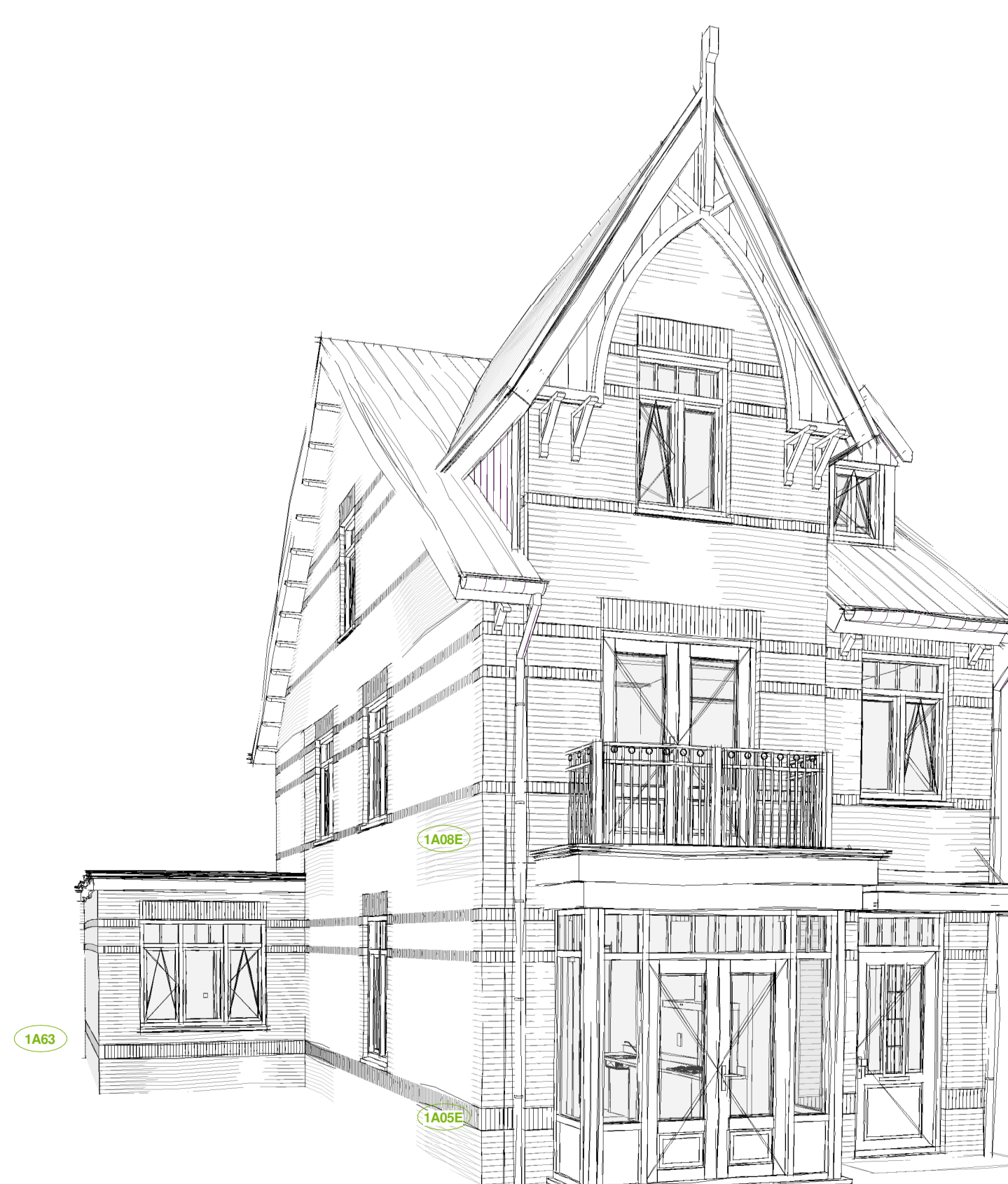
1A05E - Erker aan voorgevel 1A08E - Balkon op dak erker voorgevel 1A63 - Garage betrekken bij woonkamer
